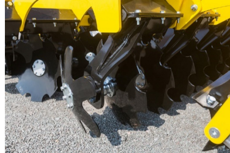
A tárctalapokat, csapágyházakat és tartókarokat összefogó csavarkötések speciális alátétekkel vannak biztosítva a vibráció okozta kilazulás ellen.
