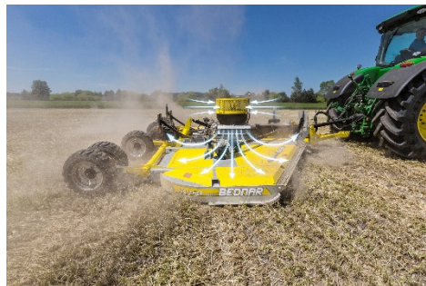
A Trash-Fan a 4,5; 6 és 7 m-es munkaszélességű szárzúzókra szerelhető fel.
