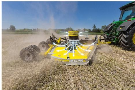
Le dispositif Trash-Fan a été conçu pour les broyeurs de résidus de moisson offrant une prise de 4,5 à 7 mètres.
