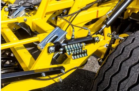
Grâce aux rondelles de distancement situées sur les rouleaux hydrauliques, le réglage de la profondeur de travail est très rapide.
