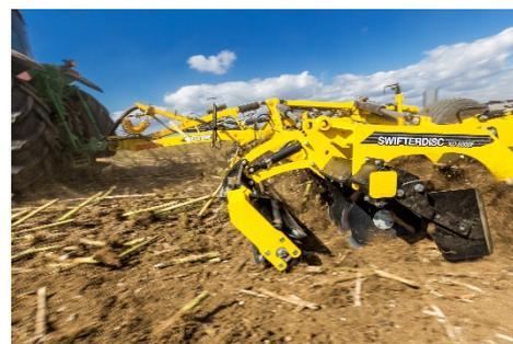
*La nouvelle génération de déchaumeurs à disques SWIFTERDISC peut également être équipée d'un rouleau avant coupant Trash Cutter.*
