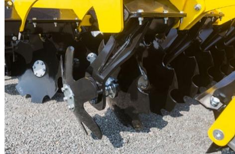
Les raccords vissés situés entre les disques, les capots des roulements et les bras sont protégés par des rondelles anti-vibrations qui les empêchent de se desserrer de manière indésirable.
