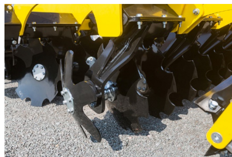
Šroubové spoje mezi disky, ložiskovými domečky a slupicemi jsou chráněny proti nežádoucímu povolování antivibračními podložkami
