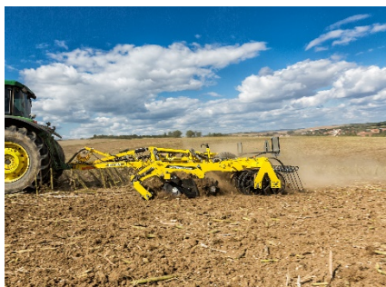
Inovaci prošla celá výrobní řada diskových podmiťáčů SWIFTERDISC
