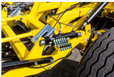
Rychlé nastavení pracovní hloubky pomocí vymezovacích podložek na hydraulických válcích
