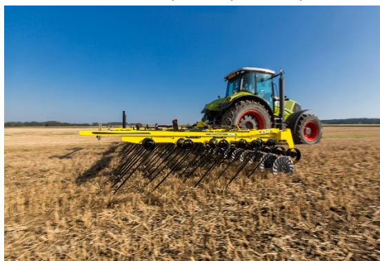
Борона для соломы STRIEGEL-PRO PN будет предлагаться шириной 6, 7,5 and 9 метров
