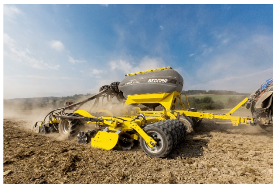
Siewnik OMEGA OO_L jest wyposażony w talerze robocze średnicy 460 mm.
