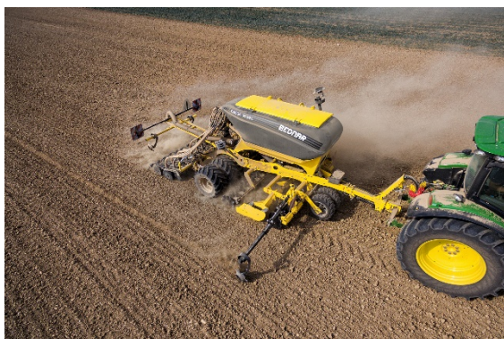
Nowa generacja siewników OMEGA OO_L ze zbiornikiem zrobionym z polietylenu w wersjach 3 i 6 metrowych.
