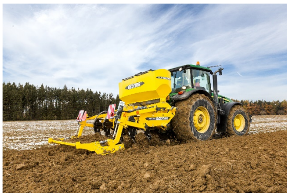
Az 1500 l térfogatú FERTI-BOX FB 1500 TN tartály a függesztett TERRALAND lazítókra szerelhető fel.
