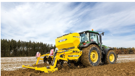
La trémie FERTI-BOX FB 1500 TN d'un volume de 1500 l pourra être installée aussi bien sur les charrues à dents TERRALAND actuelles que sur les modèles à venir.
