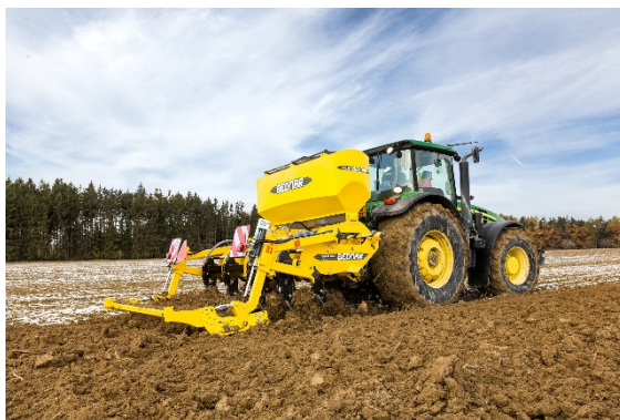
Zásobník FERTI-BOX FB 1500 TN o objemu 1500 l lze osadit na nové i současné dlátové pluhy TERRALAND
