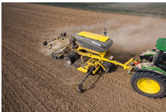
Nová generace secích strojů OMEGA OO_L se zásobníkem vyrobeným z polyetylenu bude nabízena v pracovních záběrech 3 a 6 metrů
