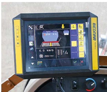
Als ISO-Bus-Maschine kann laut Hersteller jedes zertifizierte Terminal genutzt werden. Alternativ bietet Bednar Monitore von Müller-Elektronik an.
