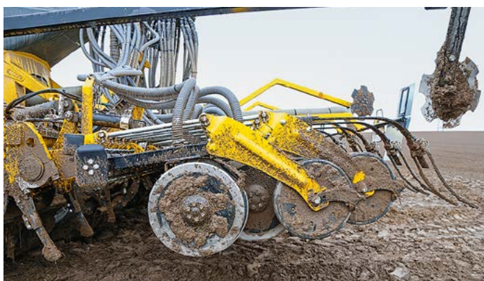
Die beiden Einzelscheiben eines Schares sind im Offset angeordnet. Die Tiefenführung erfolgt per Parallelogramm und Druckrolle.
