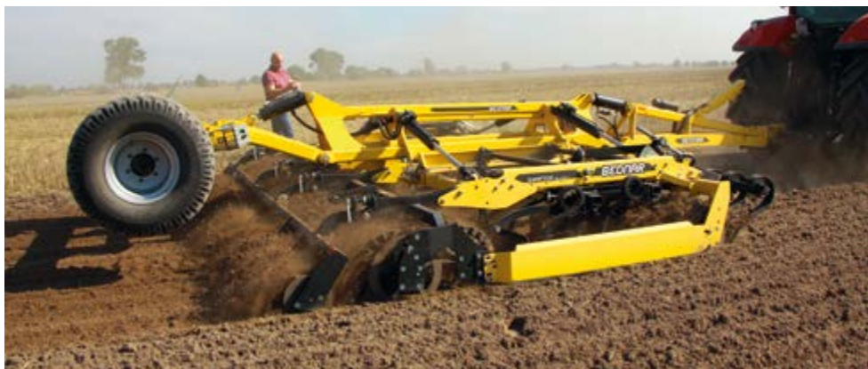
Do prac przedsiewnych Bednar zaleca m.in. kompaktor Swifter, który intensywnie rozkrusza, uprawia i wtórnie zagęszcza glebę.
