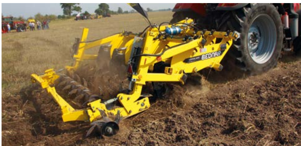
Pług dłutowy Terraland to dobry wybór do głębokiego przewietrzania gleby. Jego łapy mogą osiągać aż 65 cm głębokości.
