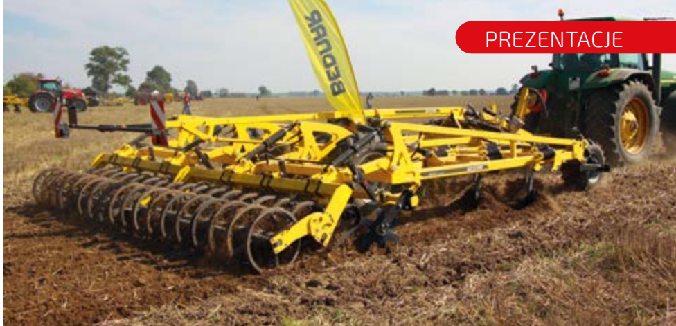
Fenix to grupa kombinowanych narzędzi uprawowych, do pracy na ściernisku i głębokiego spulchniania gleby. Aby narzędzie to stabilnie pracowało w polu – producent zaprojektował przednie koła podporowe, połączone z systemem regulacji głębokości kultywatora.
