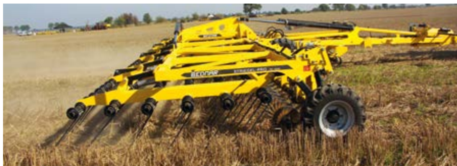
Do równomiernego rozłożenia słomy oraz wzmaganie kiełkowania samosiewów Bednar proponuje użycie brony palcowej Striegel Pro. Narzędzie to może służyć także do „przykrywania” gnojowicy.
