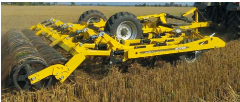
Versatill to 5-belkowy kultywator łapowy, w którym sposób ułożenia elementów roboczych sprawia, że uprawiana gleba jest podcinana na całej szerokości roboczej.
