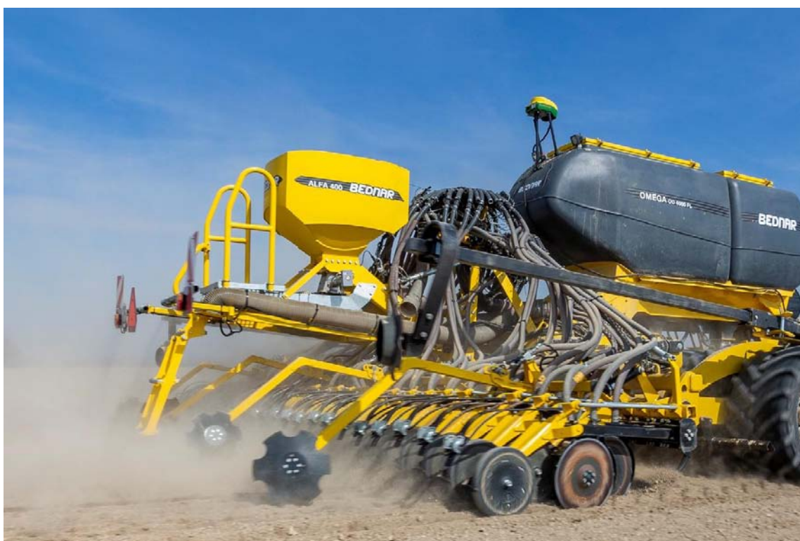
Při zakládání porostů s pomocnou plodinou probíhalo přihnojení k osivu máku ze secí jednotky ALFA DRILL umístěné na secím stroji OMEGA OO 6000 FL přímo do řádku osiva máku (foto BEDNAR FMT).
