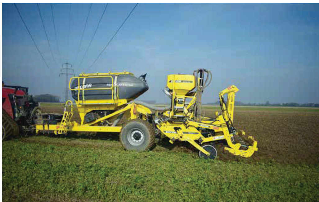
Do pokusů byl zařazen nový stroj pro pásové kypření a ukládání hnojiva s názvem TERRASTRIP.
