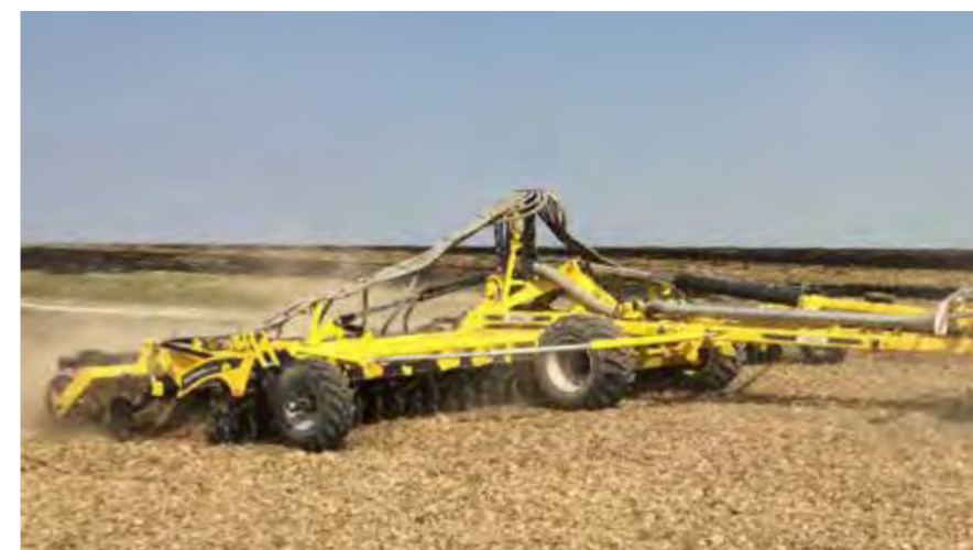
Растения для получения зеленых удобрений можно легко посадить, используя FERTI-BOX, присоединенный к SWIFTERDISC XE 10000 или XE 12000.
