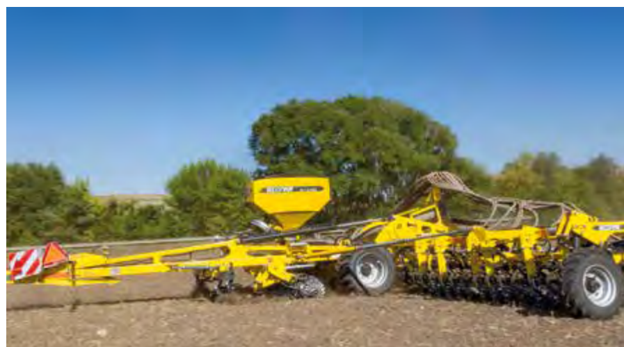
Посадка культур для внесения зеленых удобрений при культивации пожнивных остатков с помощью ALFA DRILL.
