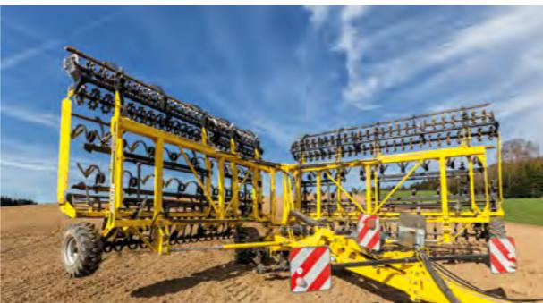
Combinatorul lat SWIFTER SE poate fi pliat în poziția de transport din cabina tractorului. Plierea complet hidraulică a secțiilor de lucru înainte spre bara de tractare asigură dimensiuni compacte de transport de până la 3 metri lățime, necesare pentru transportul rutier în țările UE.
