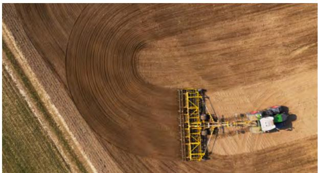
Construcția combinatorului SWIFTER SE permite virarea mașinii la capăt de rând fără a fi necesară ridicarea secțiilor de lucru. Vă recomandăm ca, la capete de rând, să virați cu viteze de lucru mai mici și la o rază de bracaj mai mare. Tijele de conectare telescopice stabilizează cadrele laterale nu numai la virare, ci și la viteză de lucru mai mare.
