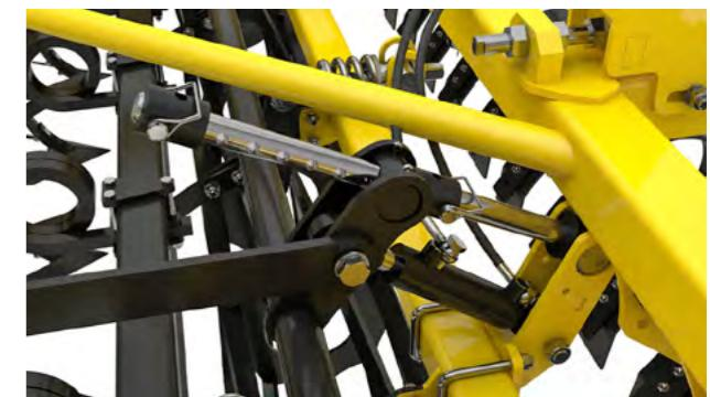
Reglarea hidraulică a adâncimii de lucru se face ușor și confortabil din cabina tractorului.
