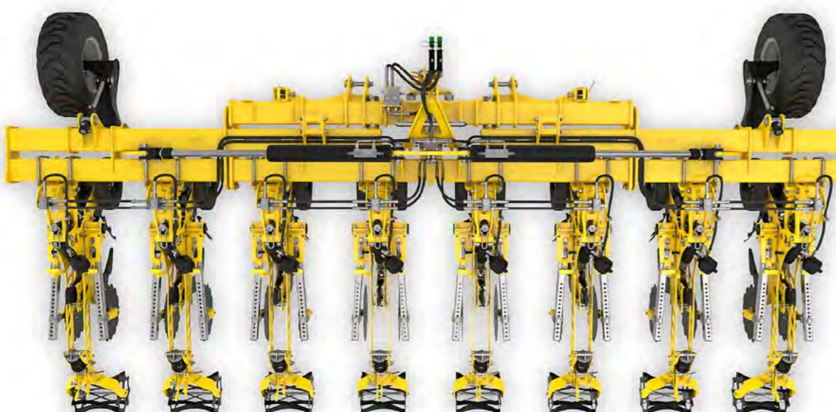
STRIP-MASTER EN cu 8 secții – distanță între rânduri de 70/75/80 cm
