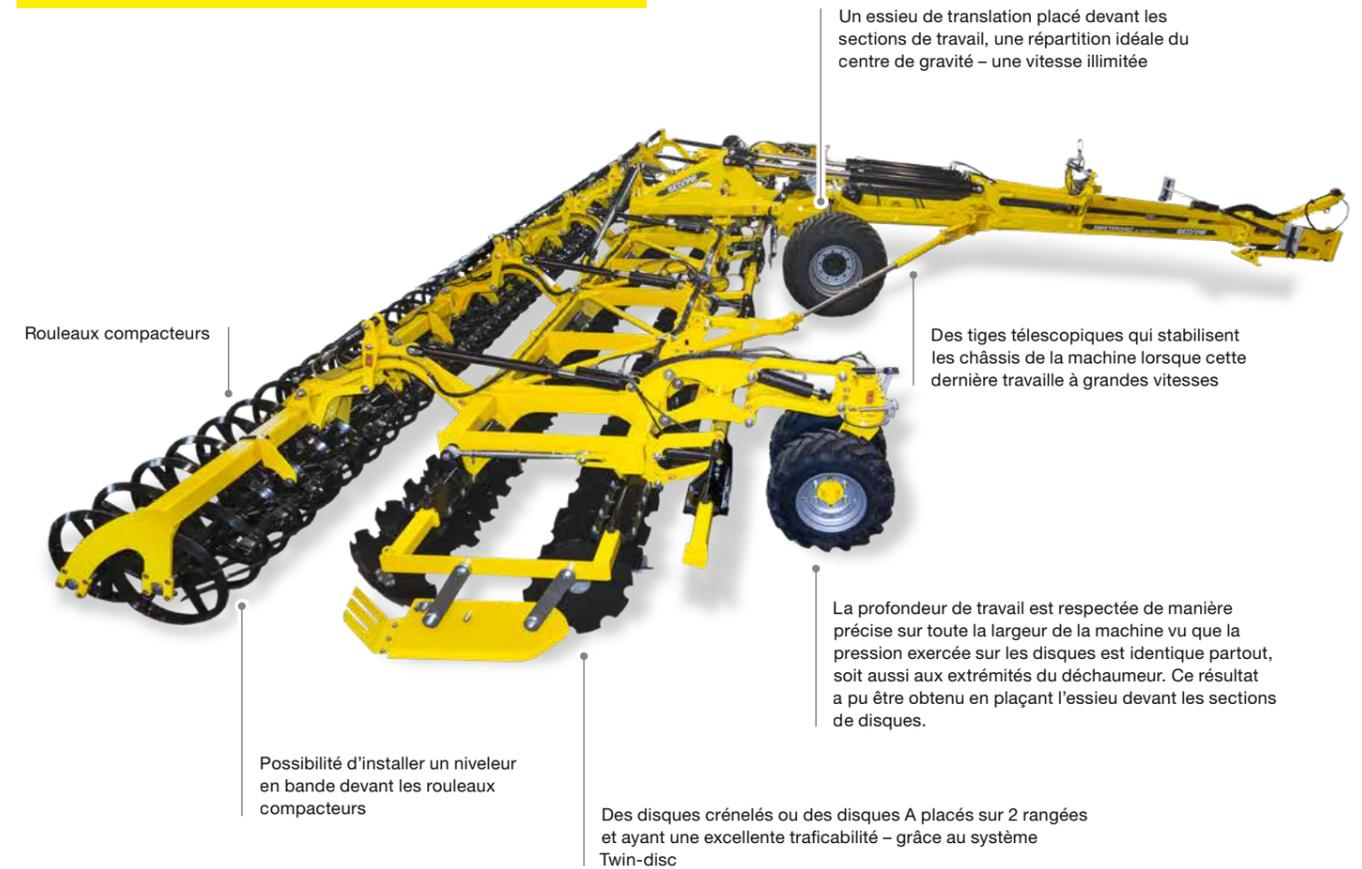
**BEDNAR SWIFTERDISC XE\_PROFI** est un déchaumeur à disques qui a été conçu pour être attelé à des tracteurs de 350 à 620 chevaux
