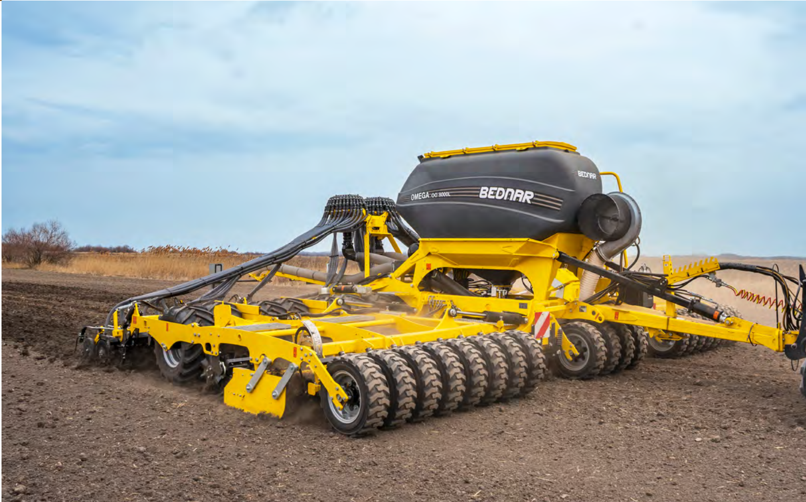
Los discos montados independientemente trabajan en la misma línea que los elementos de siembra traseros.
