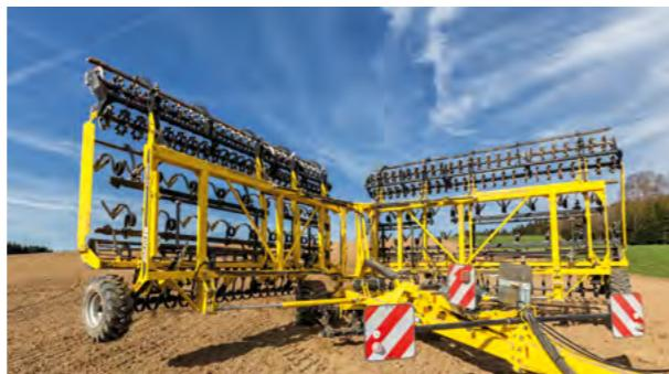
Širokozáběrový kompaktor SWIFTER SE lze do přepravní polohy složit snadno z kabiny traktoru. Plně hydraulické skládání pracovních sekcí směrem dopředu na oj dává stroji kompaktní přepravní rozměry do 3 metrů transportní šířky, nutné pro přepravu na pozemních komunikacích v zemích EU.
