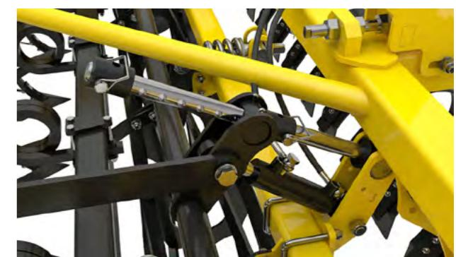
Hydraulické nastavení zaručuje snadné a komfortní nastavení pracovní hloubky přímo z kabiny traktoru.
