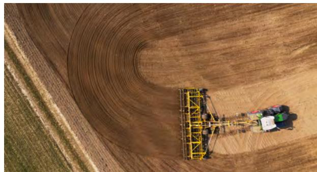
Kompaktor SWIFTER SE umožňuje díky své konstrukci plynulé otáčení na souvrati bez nutnosti zvedání pracovních sekcí. Doporučujeme otáčení na souvrati provádět se sníženou pracovní rychlostí a s větším poloměrem otáčení. Ke stabilizaci bočních rámů nejen během otáčení, ale i při vyšších pracovních rychlostech, slouží teleskopická táhla.
