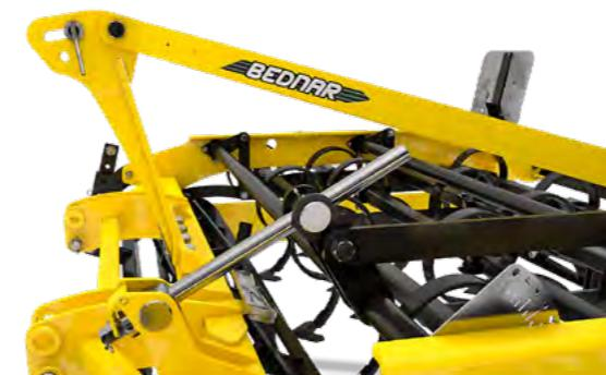
Pracovní hloubka se nastavuje pomocí trapézového šroubu s odnímatelnou klikou. Přesné nastavení v celém pracovním záběru pro každou sekci zaručuje číselná stupnice s ukazatelem.
