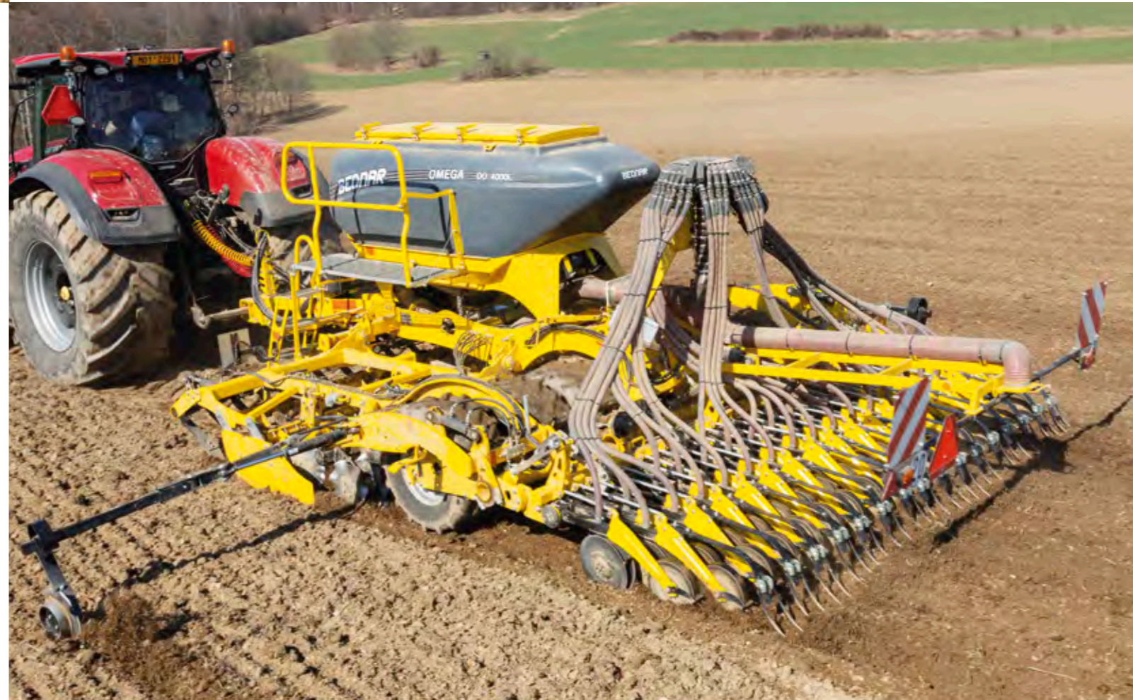
Незалежно встановлені колтери працюють по тій же лінії, що і висіваючі сошники
