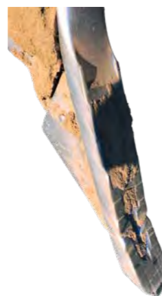
Долото LONG-LIFE після напрацювання 700 га
