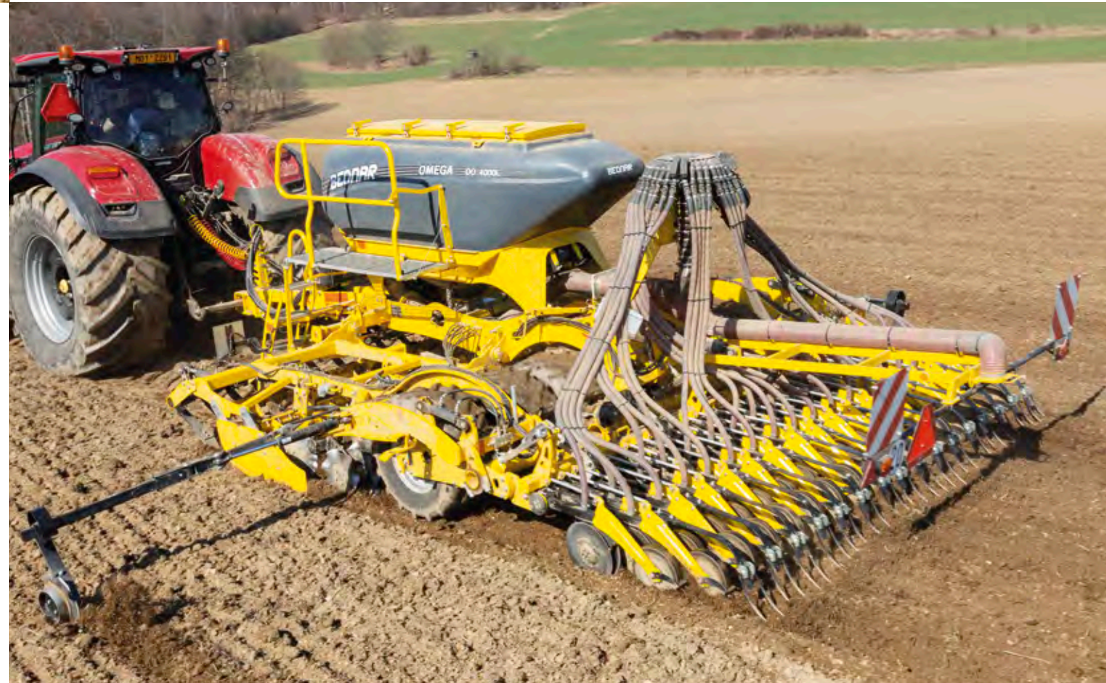
Независимо смонтированные сошники работают в той же линии, что и задние сошники сеялки
