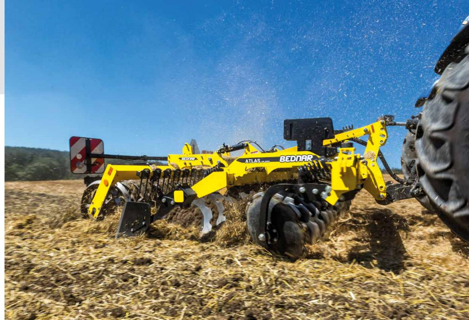
**Навесные дисковые культиваторы BEDNAR ATLAS AN\_PROFI** оснащены дисками диаметром 620 мм. Эти компактные культиваторы созданы для малых ферм.
