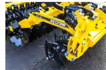
3 метровая модель имеет механические складывающиеся диски, или гидравлические, которые доступны за дополнительную плату. Гидравлическое складывание очень удобное, особенно если фермеру нужно работать на разных земельных участках несколько раз в день. Благодаря конструкции машина соответствует требованиям работы на дорогах. Ширина – до 3м. Когда боковые диски сложены, машина имеет рабочую ширину 3 м.
