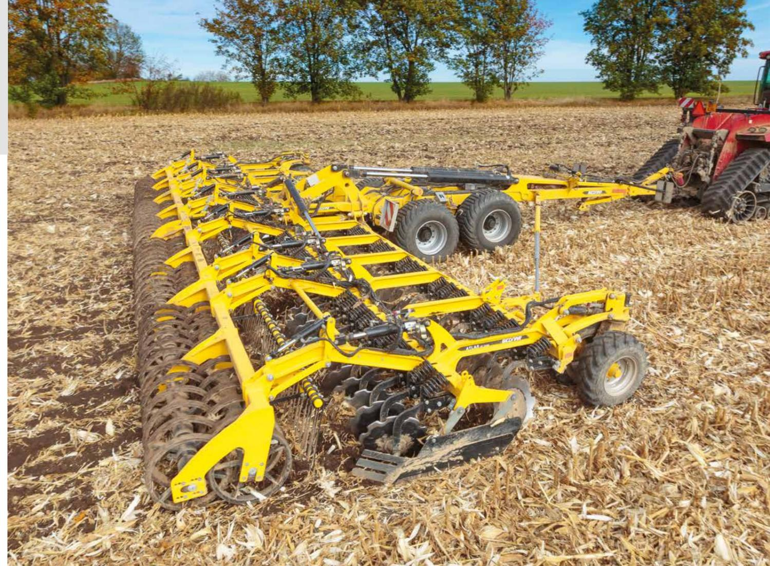
**BEDNAR ATLAS AE\_PROFI – тяжелый, ведомый, широкий дисковый культиватор прочной конструкции для пожнивной обработки с большим количеством растительных остатков.** Общая конструкция машины позволяет работать на высоких скоростях, а рабочая ширина машины помогает ежедневно достигать прекрасных результатов.
