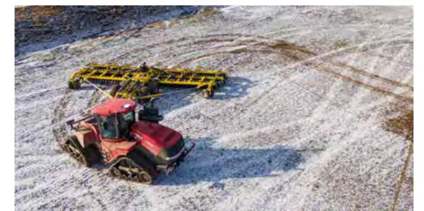
Культиватор ATLAS AE\_PROFI – это широкий культиватор, который обладает высокой маневренностью благодаря своей конструкции даже на поворотных полосах. Машина разворачивается на задних катках и опорных передних поворотных колесах. Это решение устраняет отрицательную нагрузку на сцепное устройство и выгружает трактор, когда машина находится на разворотной полосе.
