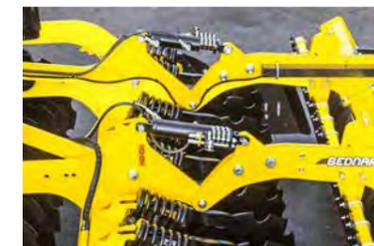
Настроить глубину машины легко и удобно, используя откидные гидравлические зажимы, расположенные на задних гидравлических цилиндрах, которые соединяют раму машины с рамой уплотняющих и разрыхляющих катков.
