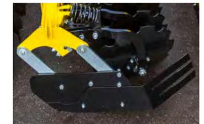
Машина может быть оборудована отражателями, которые сбивают почву, чтобы машина могла работать без проблем и не засоряться.
