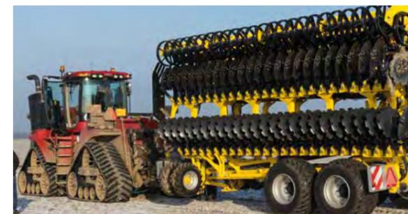
Машина ATLAS AE\_PROFI складывается вперед к тяговому брусу. В транспортном положении машина имеет ширину 3 м и высоту 4 м, включая двойные катки с V-образным или U-образным кольцом. ATLAS AE\_PROFI устойчив в транспортном положении и может быть легко транспортирован между отдельными участками земли.
