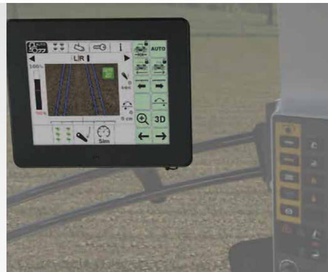
A CultiCam figyelőrendszer részét alkotja egy monitor is, amely a kezelőszemélyzet felé továbbítja a figyelt növényzettel kapcsolatos információkat.
