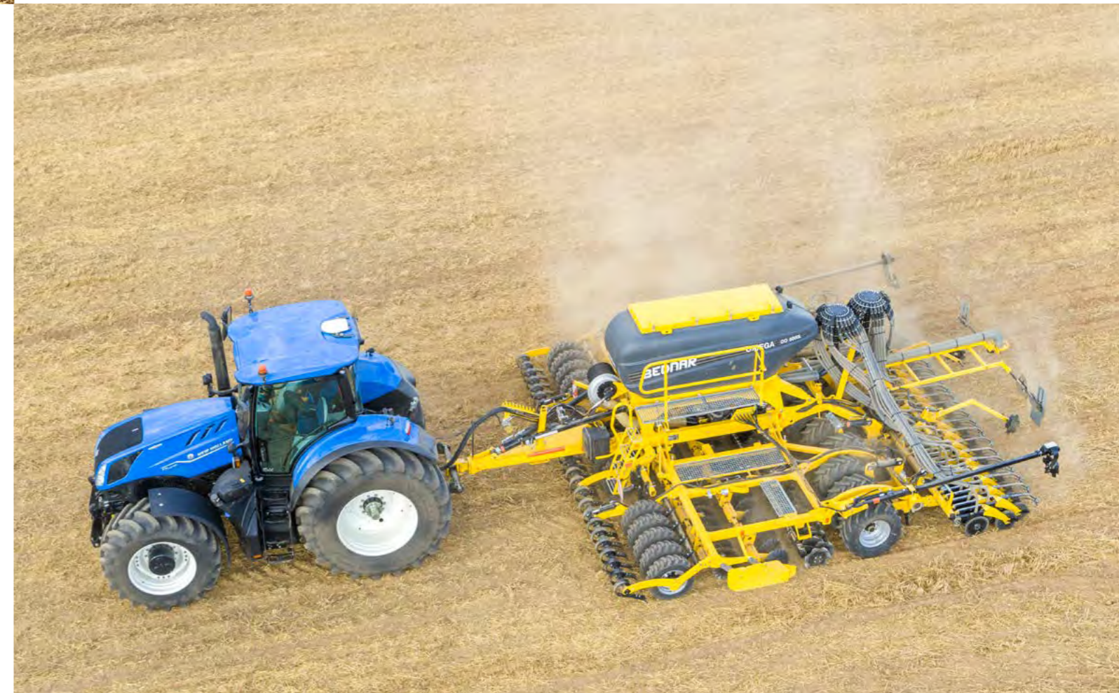
Az egymástól függetlenül szerelt csoroszlyák a hátsó vetőcsoroszlyákkal azonos vonalban lazítják a talajt.
