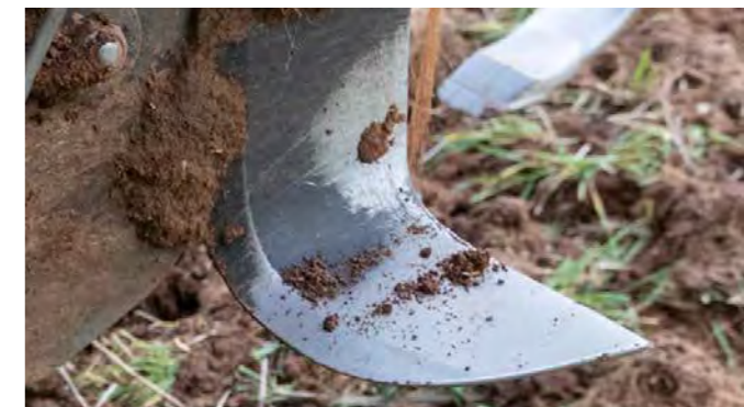
A normál szárnyak állapota 44 hektár megművelését követően
