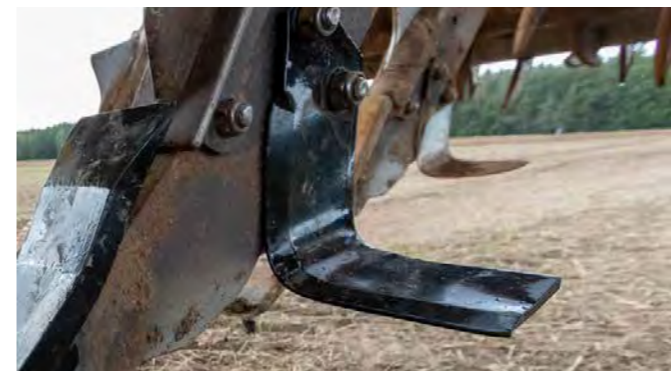
A normál szárnyak állapota 44 hektár megművelését követően
