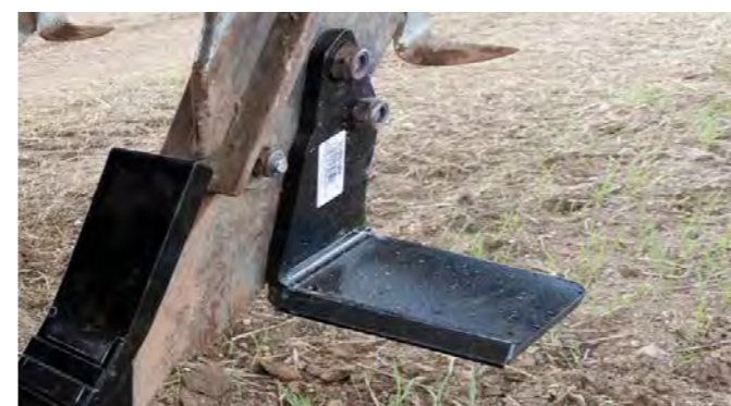
A LONG-LIFE szárnyak állapota 44 hektár megművelését követően
