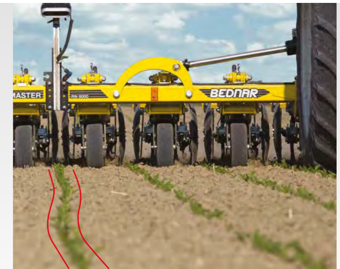
Le système d'autoguidage est capable de diriger la machine Row-Master même lorsque les plantes ont été semées en arc-de-cercle.
