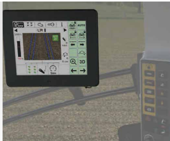
Le système de surveillance CultiCam comprend un moniteur qui transmet à l'opérateur des informations sur la détection de la végétation.
