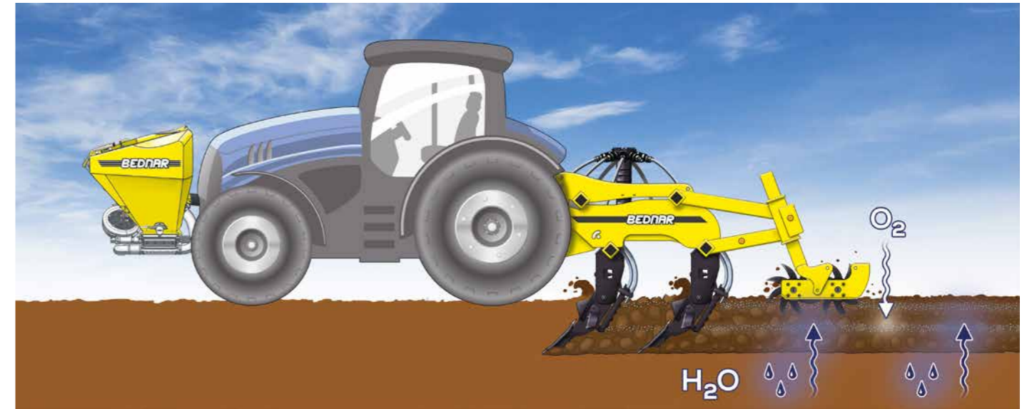
PRINTEMPS – PRÉPARATION PRINTANIÈRE DU SOL AVANT LES SEMIS, À L'AIDE D'UNE MACHINE SWIFTER ÉQUIPÉE DE SOCS SB
