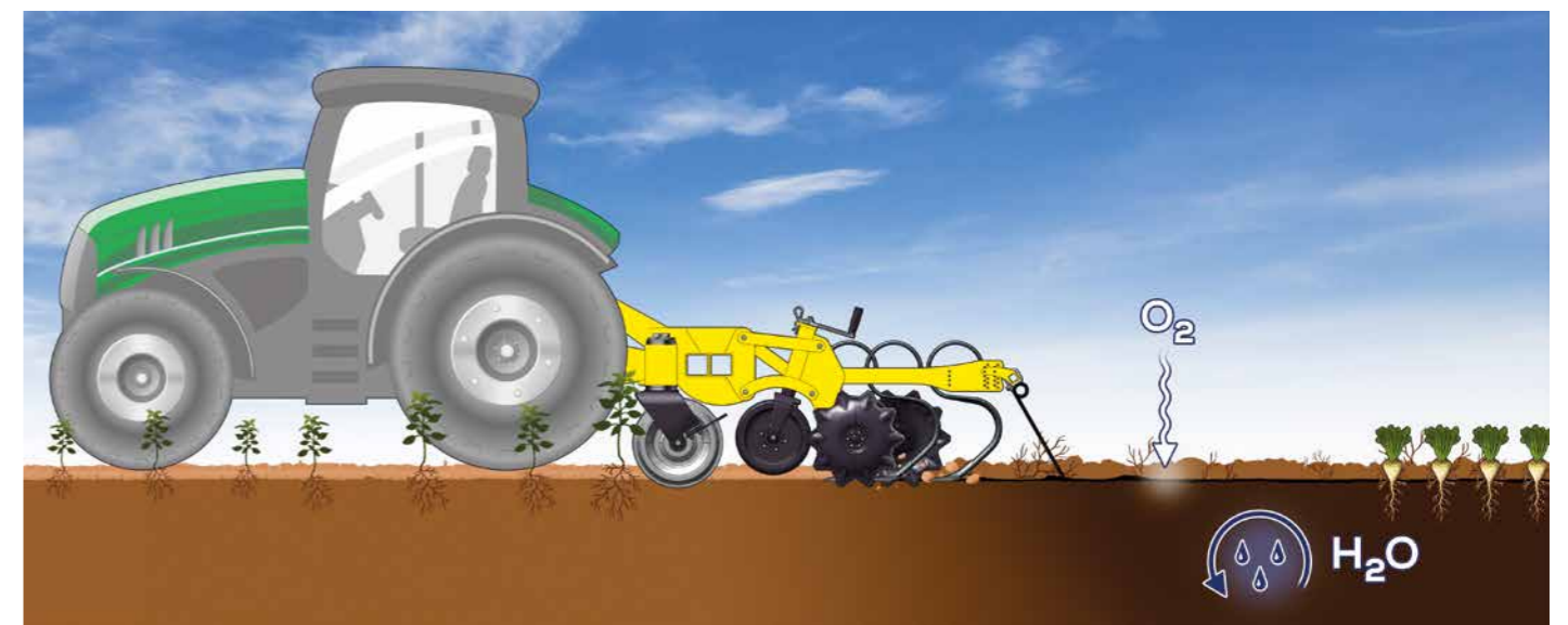
VÉGÉTATION – BINAGE ENTRE LES RANGS AVEC UNE BINEUSE ROW-MASTER
