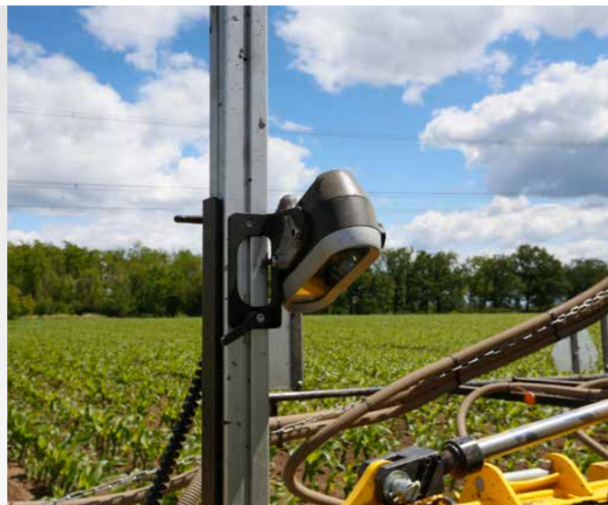
La hauteur et l'angle d'orientation de la caméra pourront être réglés en fonction du stade de croissance des plantes.
