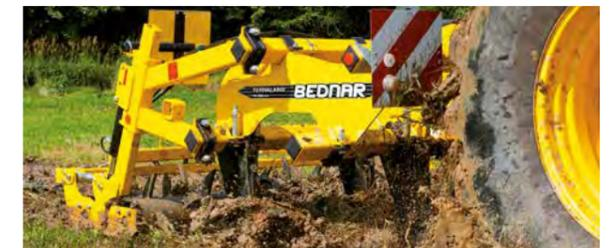
Wegen seiner Bauweise kann der TERRALAND TN auch auf den sehr stark verdichteten Flächen eingesetzt werden. Die bearbeitete (aufgelockerte) Fläche „entspannt“ sich schnell und das Wasser kann wieder versickern. Der Boden trocknet bald ab, wird gesünder und ist zur Aussaat bereit. Das nächste Mal müssen Sie sich mit dem Problem nicht mehr befassen.
