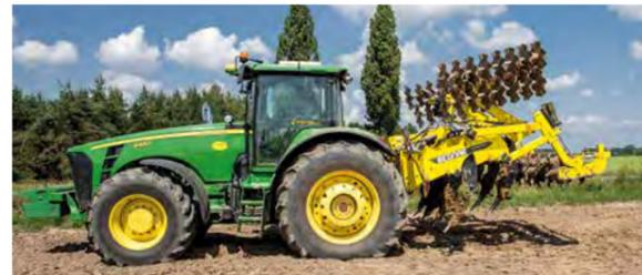
Das Cutter-Discs-Segment wird hydraulisch über die Maschine zusammengeklappt. Diese Position ermöglicht, auch ohne das hintere Cutter-Segment zu arbeiten, z.B. falls auf dem Feld eine große Menge von Pflanzenresten bleibt.
