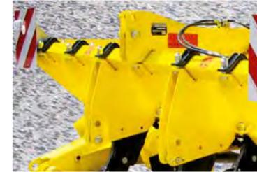
Die Maschinen TERRALAND TN und TN\_PROFI werden mit dem Schlepper mit Hilfe der 3-Punkt-Aufhängung verbunden. Die angebaute Variante ist wegen der leichten Manövrierbarkeit am Vorgewende und im öffentlichen Verkehr vorteilhaft.
