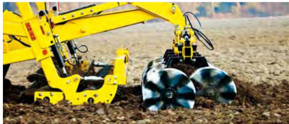
Das Cutter-Disc-Segment bilden 2 Reihen von gewellten Scheiben mit einem Durchmesser von 520x5 mm. Die Scheiben zerschneiden, mischen das Pflanzenmaterial ein und planieren die Bodenoberfläche für die Bestellung. Die Cutter-Disc greifen ineinander. Das gewährleistet den Selbstreinigungseffekt der Cutter-Disc.
