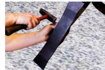
Jedes Schar ist mit dem beidseitigen Meißel (80/40 mm) versehen, der mit dem Quick-Change-System leicht austauschbar ist. Im Prinzip handelt es sich um Aufstecken des beidseitigen Meißels auf das Scharendende und Befestigung mit nur einem Sicherungsbolzen. Das System Quick-Change bietet einen hohen Benutzerkomfort.
