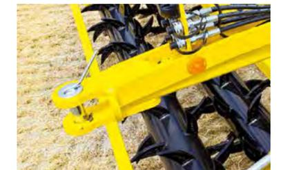
TERRALAND TO ist mit einer Anhängervorrichtung mit je einem hydraulischen und elektrischen Anschluss ausgestattet und dient zum Ziehen von zusätzlichen Arbeitsgeräten. Es handelt sich um die gezogenen Ackerwalzen CUTTERPACK oder PRESSPACK, die der Tiefenlockerung folgen können und somit bei schwersten Böden perfekte Rückverfestigung erzielen.
