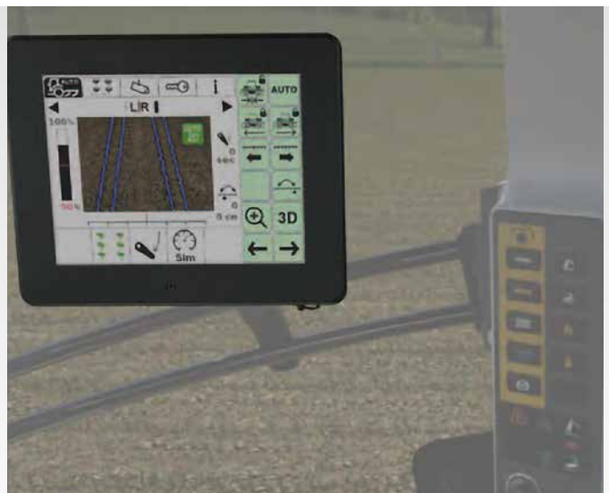
Das Leitsystem von CultiCam enthält einen Monitor, der dem Benutzer Informationen über die Erkennung von Vegetation zur Verfügung stellt.
