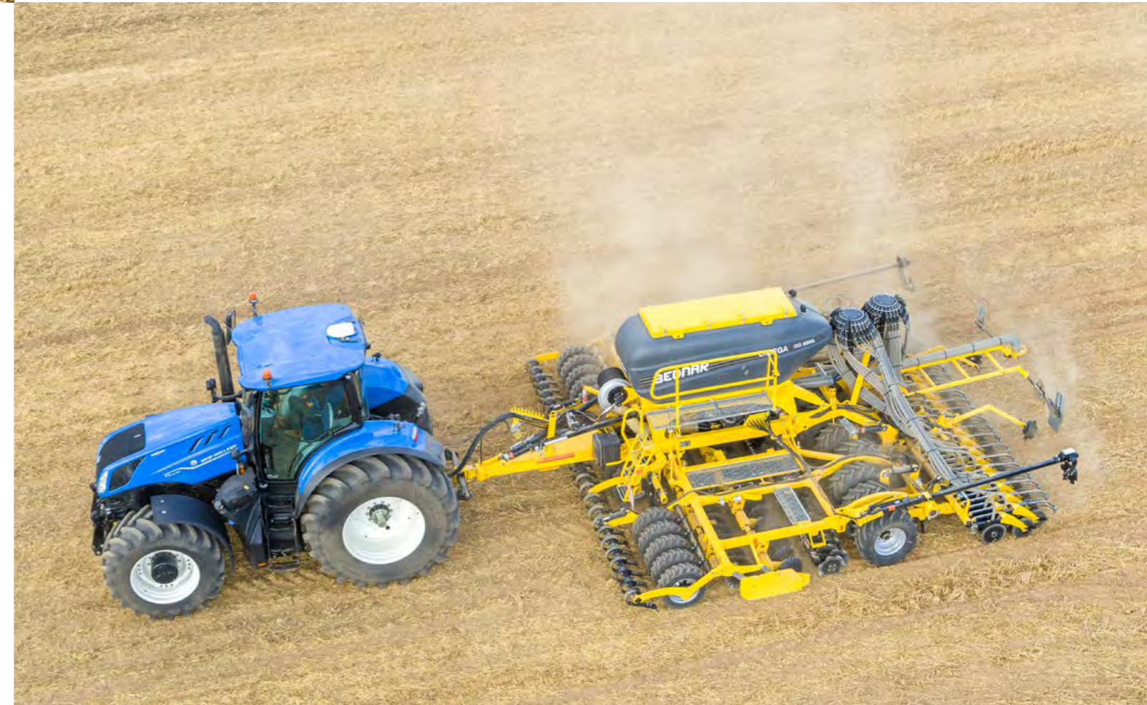
Die unabhängig voneinander aufgehängten Coulter arbeiten in der gleichen Linie wie die hinteren Säscharen.
