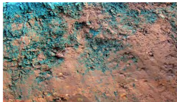
Infiltration des Wassers in den Boden auf einer Fläche mit Aussaat von Gerste
