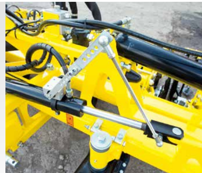
Snímač aktuální polohy rámu stroje vůči 3 bodovému závěsu.
