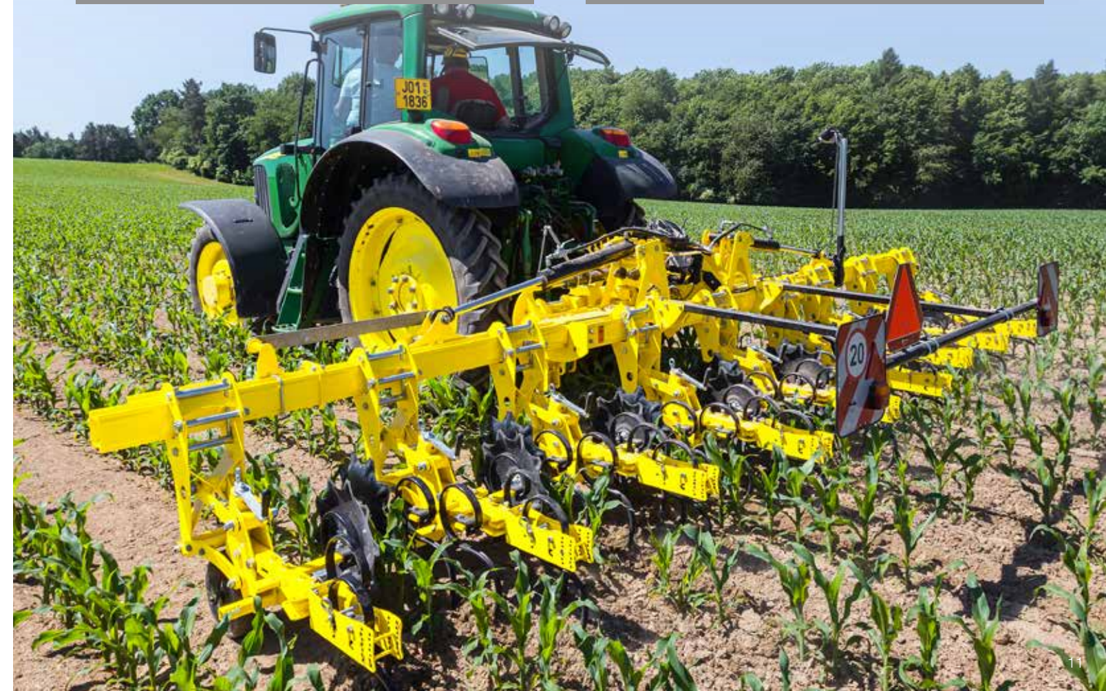
Přerušeni kapilarity v řádcích znamená snížený odpar v období sucha
